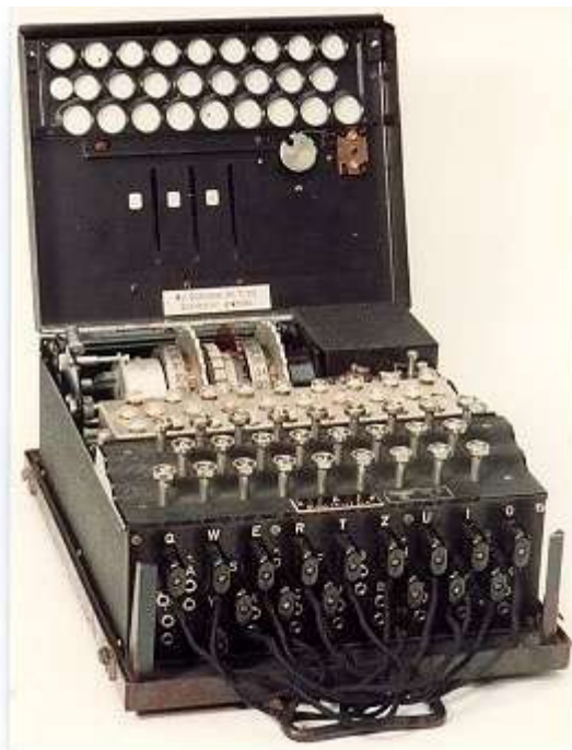
Hình 2-2. Hình minh họa cấu trúc máy ENIGMA, gõ chữ vào bàn phím, bản mã hiện ra ở các bóng đèn bên trên. (nguồn: Wikipedia)
